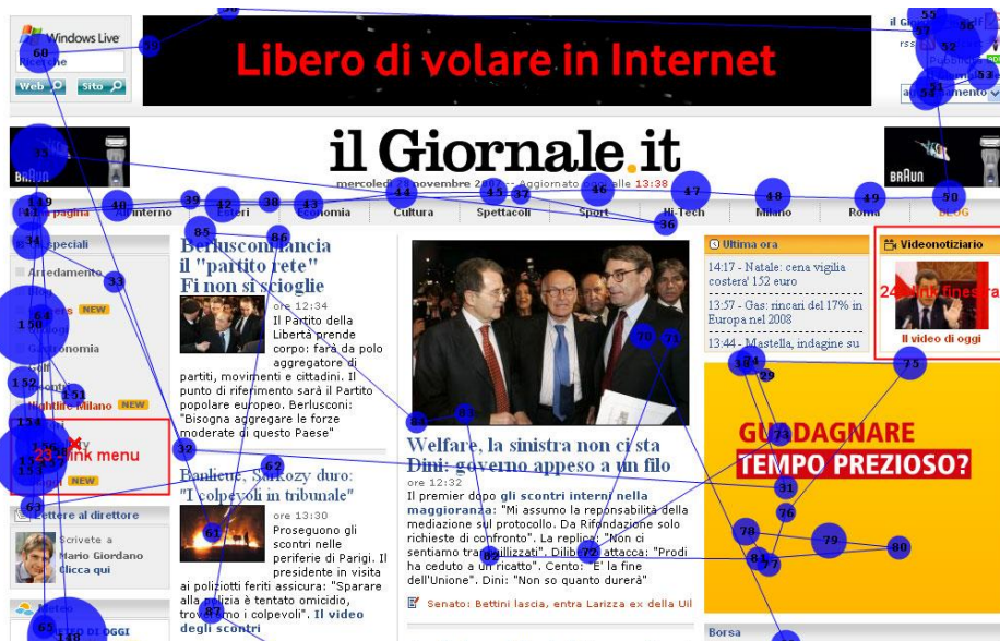
Figura 32: Esempio di un gaze plot "complesso" che mostra la ricerca di un link posto nell'area evidenziata da un rettangolo rosso a sinistra.
